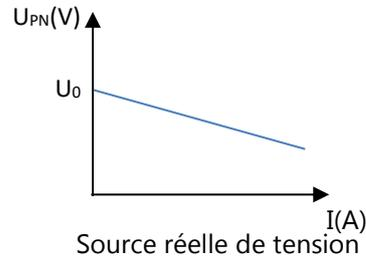
**Rq :** Pour une source réelle de tension, le coefficient directeur de la droite correspond à la résistance interne  $r$ .
