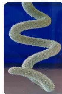
⇒ Il se forme un dépôt de paillettes argentées sur le cuivre et la solution incolore de nitrate d'argent se colore en bleu.
